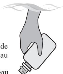
Rincer le flacon de l'échantillon d'eau (0688 Oxygène dissous) avec l'eau de l'échantillon.
