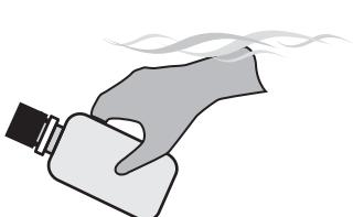
Tape bien el frasco y sumérjalo hasta la profundidad deseada.
