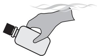
Fermer hermétiquement le flacon, et le plonger à la profondeur souhaitée.
