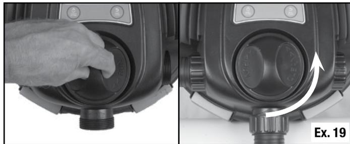
**REMARQUE :** s'il n'a pas été utilisé depuis un certain temps, le robinet peut être un peu difficile à tourner. N'utilisez aucun outil pouvant fissurer la poignée. L'ensemble robinet peut être retiré du couvercle pour son nettoyage et sa lubrification en utilisant de la graisse de silicone. Nous recommandons cette opération si le robinet est difficile à tourner.
